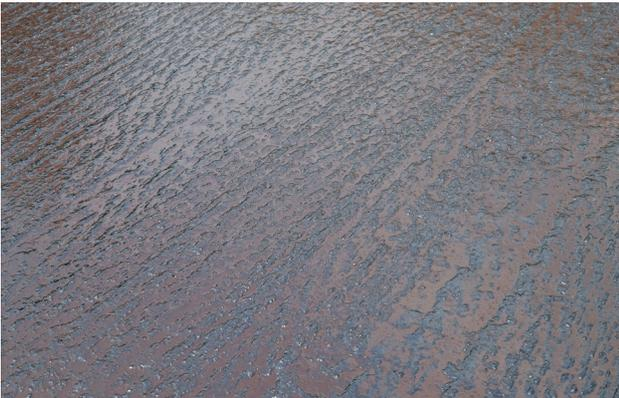
Teilgebrochene polymermodifizierte Bitumenemulsion
