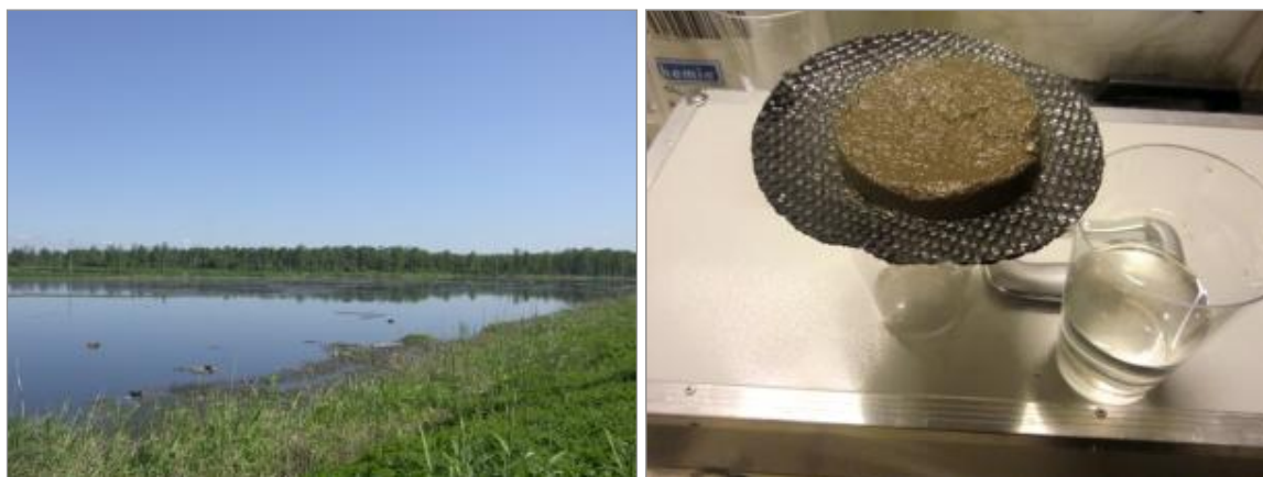
Figure 3 : Lagune de décantation de boues (à gauche) et séparation phase liquide/phase solide par essorage (à droite)
