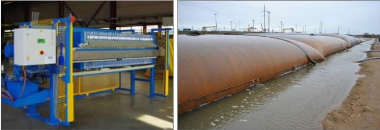
Figure 4 : Déshydratation mécanique par filtre à presse (à gauche) et déshydratation statique au moyen de tubes géosynthétiques (à droite)
