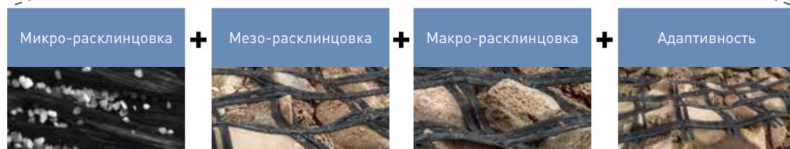
Грубая текстура поверхности георешетки достигает микроскопической расклинцовки с частицами грунта (трение).
