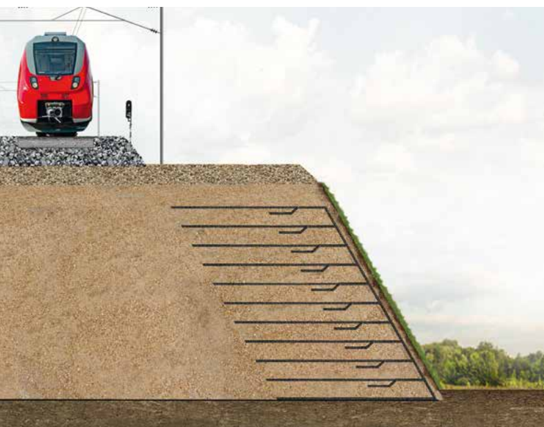
Подпорные стены/ откосы повышенной крутизны
